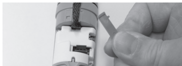
Rysunek (9) Osłona do mocowania sznurka do noszenia
