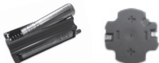
Slika (3) Vstavljanje akumulatorske baterije
