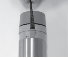
Kuva (24) Kantonarun asentaminen
