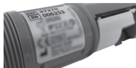
Figura (8) Placa de especificações com todas as características de identificação
