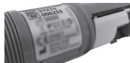
(8) pav. Duomenų plokštelė su visais identifikatoriais
