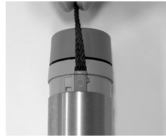
Figura (24) Montagem do fio de transporte
