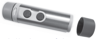
Εικόνα (2) Αφαίρεση της υποδοχής της μπαταρίας
