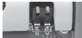
Rysunek (10) 2 mikroprzełączniki do ustawiania częstotliwości dźwięku
