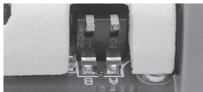
Εικόνα (10) 2 διακόπτες DIP για ρύθμιση της συχνότητας ήχου
