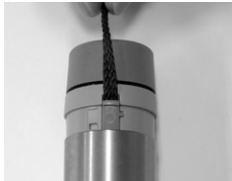
Figura (24) Montaje del cable de transporte
