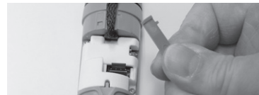
Rysunek (9) Osłona do mocowania sznurka do noszenia
