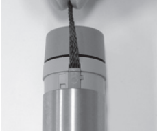
Kuva (24) Kantonarun asentaminen
