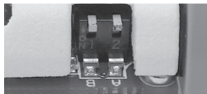
Obrázok (10) 2 DIP prepínače na nastavenie frekvencie tónu
