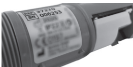
Εικόνα (8) Πινακίδα τύπου με όλα τα χαρακτηριστικά αναγνώρισης
