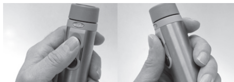
Obrázok (13) Ovládanie tlačidiel nakláňaním palca
