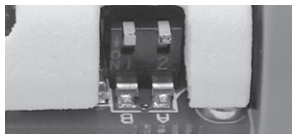
Figure (10) 2 commutateurs DIP pour la réglage de la fréquence de tonalité
