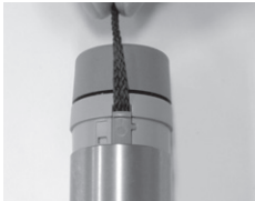
Figura (24) Montaje del cable de transporte
