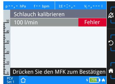
Wenn Sie keine Schlauchkalibrierung vornehmen, werden die Kalibrierdaten der letzten Schlauchkalibrierung verwendet. Bei Erstinbetriebnahme kommen dagegen die im Gerät hinterlegten Standard-Kalibrierdaten<sup>1</sup> zur Anwendung.
